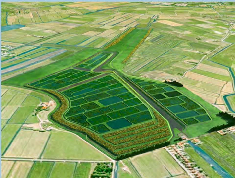
Volgermeerpolder: Herontwikkeling – met gebruik van nieuwe technieken, branding en belangrijke inbreng van de omgeving. Natuurontwikkeling en zelfverzorgende ‘natural cap’ om chemisch afval te isoleren (bron: Stichting Burgerkomitee Volgermeerpolder - of site: volgermeerpolder.nl)
