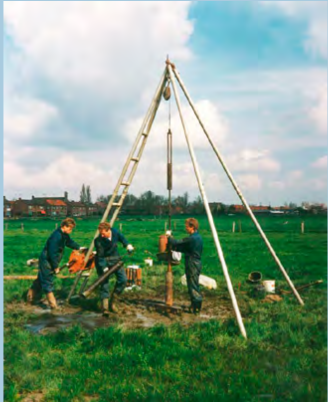
Pulsaboring nabij het voormalige Dagra-terrein in Bunschoten (foto Hans de Waal)
